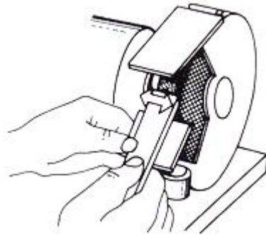
Rys. 42. Ostrzenie noża na ostrzarce elektrycznej [6, s. 176]
