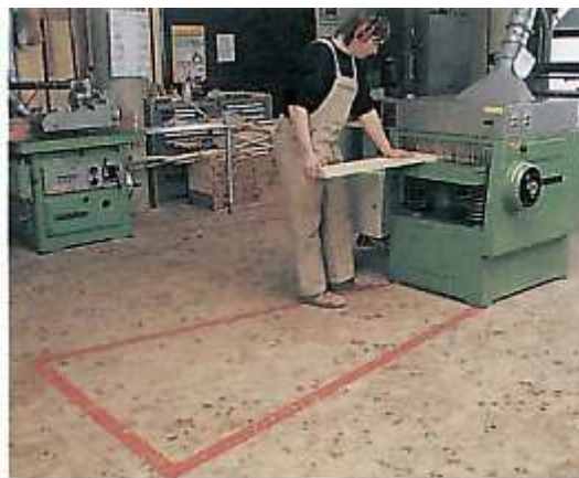
Rys. 4. Podczas pracy na maszynie należy unikać przebywania w obszarze niebezpieczeństwa [6 s, 109]
