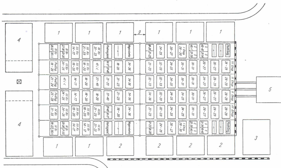
Rys. 4. Kłodowisko z ręcznym rozwozem kłód: 1 – stoły manipulacyjne dłużyc dowożonych ciągnikami i samochodami, 2 – stoły manipulacyjne dłużyc dowożonych wagonami kolejowymi, 3 – zapasowa mygła dłużyc z dowozu kolejowego, 4 – zapasowe mygły dłużyc dowiezionych transportem samochodowym, 5 – hala przetarcia [4, s. 100]
