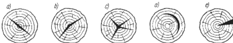
Rys. 27. Pęknięcia czołowe drewna okrągłego: a) rdzeniowe proste, b) rdzeniowe załamane, c) rdzeniowe gwieździste, d) okrężne, e) z przesychania [3, s. 66]
