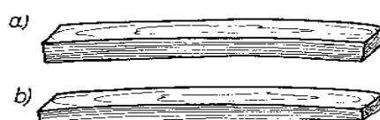
Rys.3. Bazowanie elementu podczas wyrównywania: a) przed wyrównaniem, b) po wyrównaniu [3, s.122]
